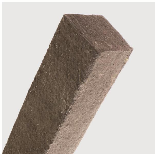
Le produit se compose d'un matériel intumescent à base de graphite résistante au feu. La bande s'adapte à sceller le passage d'un faisceau de câbles, le passage de clapets coupe-feu avec un espace inférieur à 30 mm, à sceller les joints de dilatation et les fissures entre les parois et les dalles.
